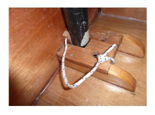
Ce qui a entraîné une modification du pied de mât, pour le rendre plus vertical, avec une découpe agrandie et l'ajout d'une cale ...
