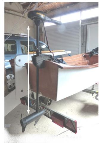
La première des opérations est donc de mettre le moteur en place sur le tableau du bateau, et de mesurer la bonne hauteur de tube à conserver. Pour cela ne pas hésiter à faire des essais, avec ou sans gouvernail, en inclinant le moteur, bref en essayant d'imaginer comment ça va se présenter à fin, voir s'il n'y aura pas une gêne pour un passage de cordage, etc ...
